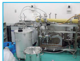
琵琶湖水実験室 琵琶湖岸に設置したポンプにより、実験室内水栓から連続的に琵琶湖水をサンプリングすることが可能
